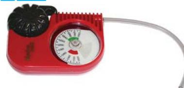
Densimetri per liquido antigelo. Semplici nell'uso e precisi nella misurazione. Lunghezza mm 200.
